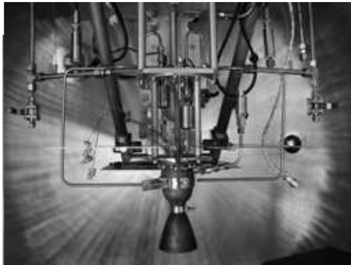
Figura 9 – Motor de 400N IAE/CTA
