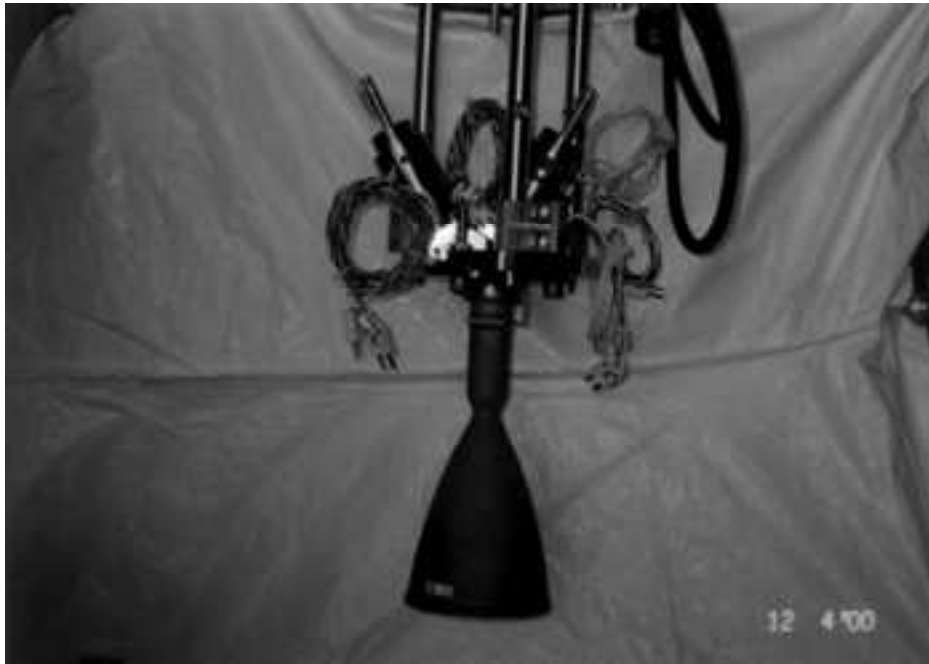
Figura 8 – Motor de 200N – Projeto ATV
